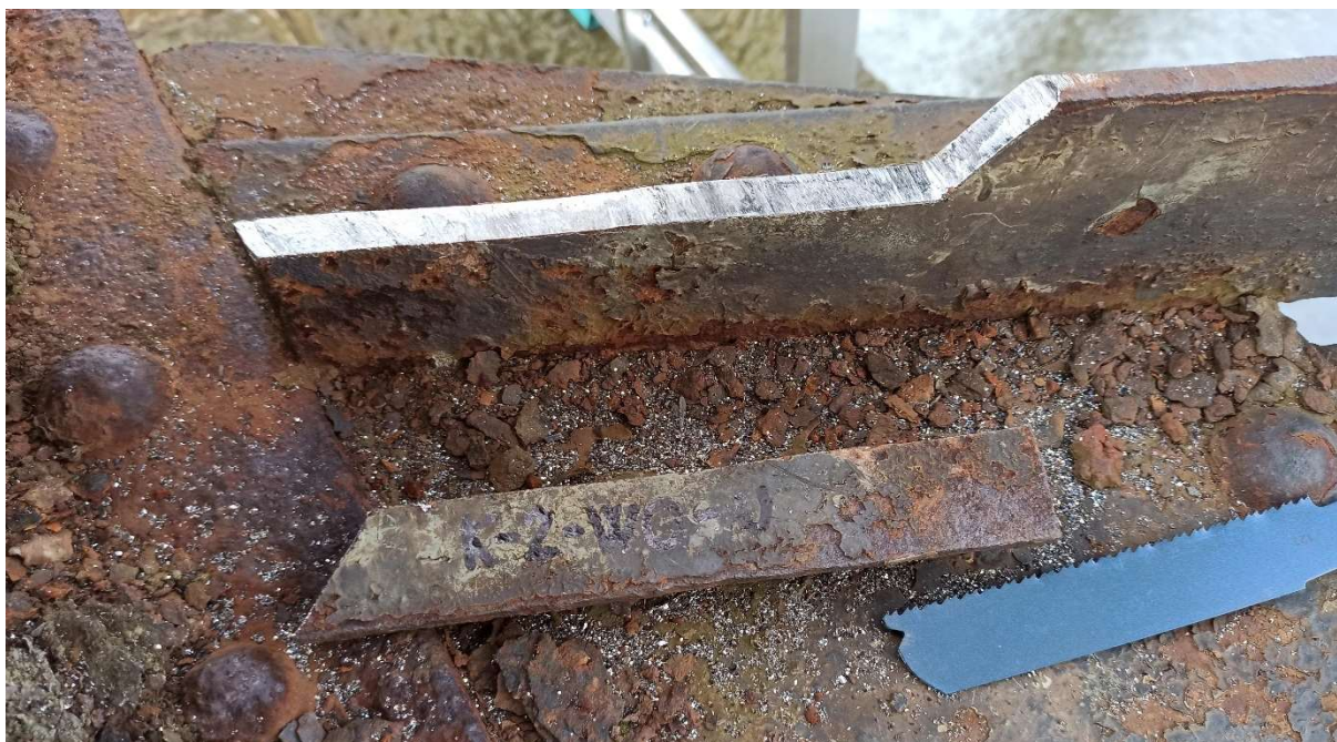
Obr. 8 Odběr vzorků, K3, úhelník vodorovného ztužení
