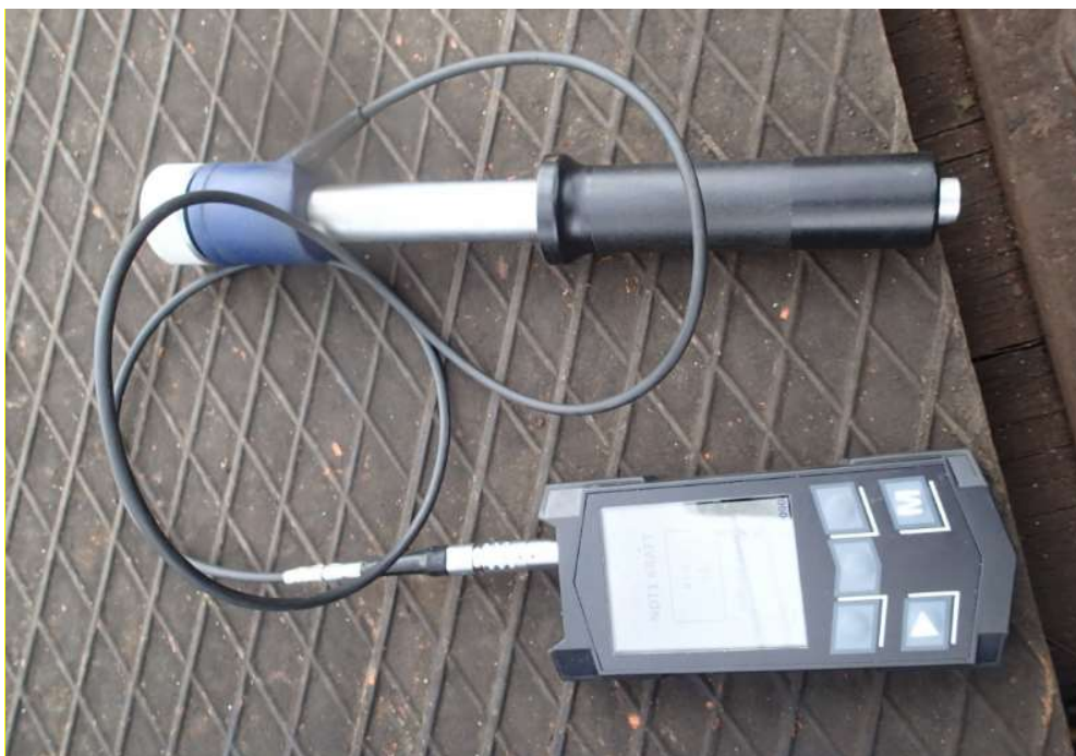
Obr. 19 Obr. 32 Tvrdoměr typu KT-C se sondou typu G
